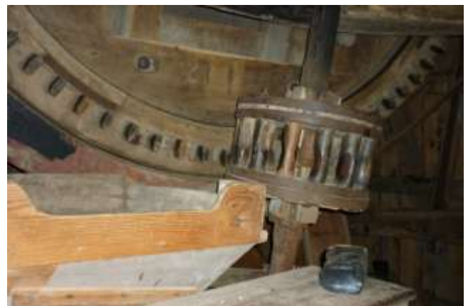
Links het grote kamwiel op de as van de wieken met aandrijving van de molensteen
